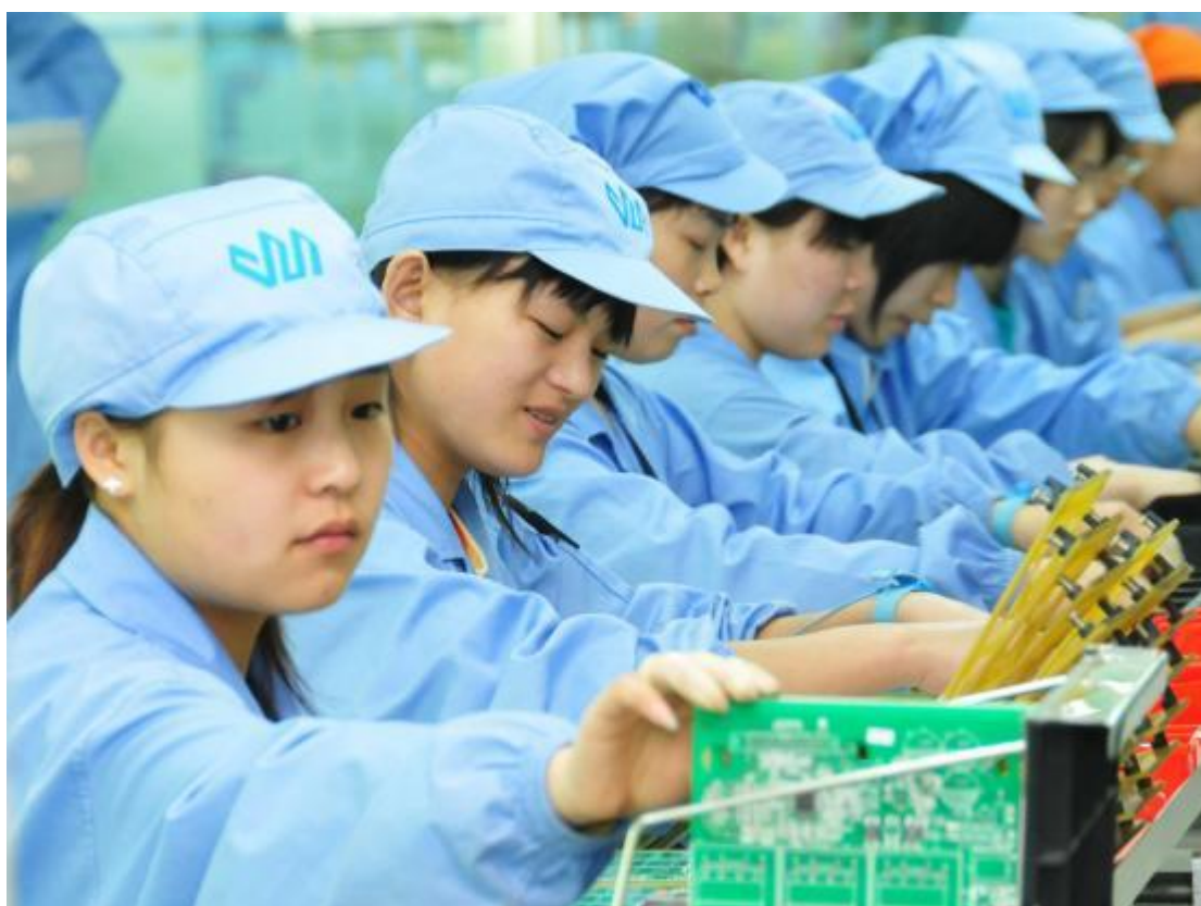
实习实训基地——电装车间插件岗位实训
